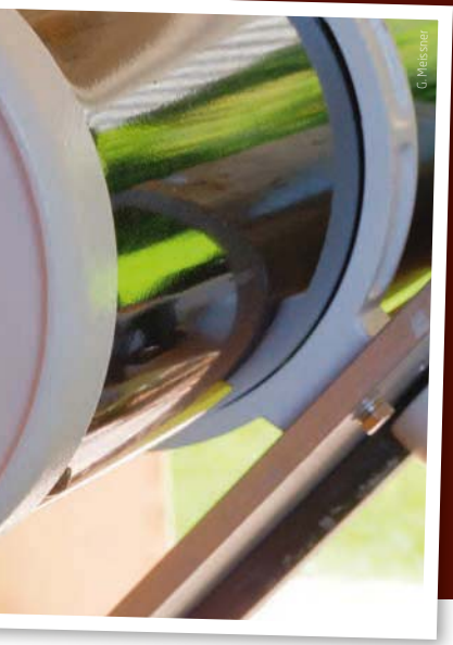
▲ Abb. 8: Der Hauptspiegel ist justiert, durch das Offset wirkt der Fangspiegel aber verschoben.
