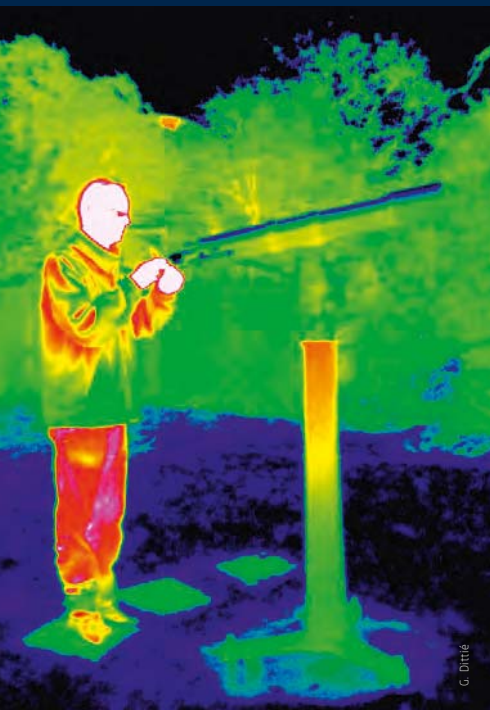
▲ Abb. 1: Das Thermogramm eines Teleskops zeigt, wie die Oberseite des Tubus durch die Infrarotabstrahlung in den Himmel auskühlt und dadurch beschlägt.
