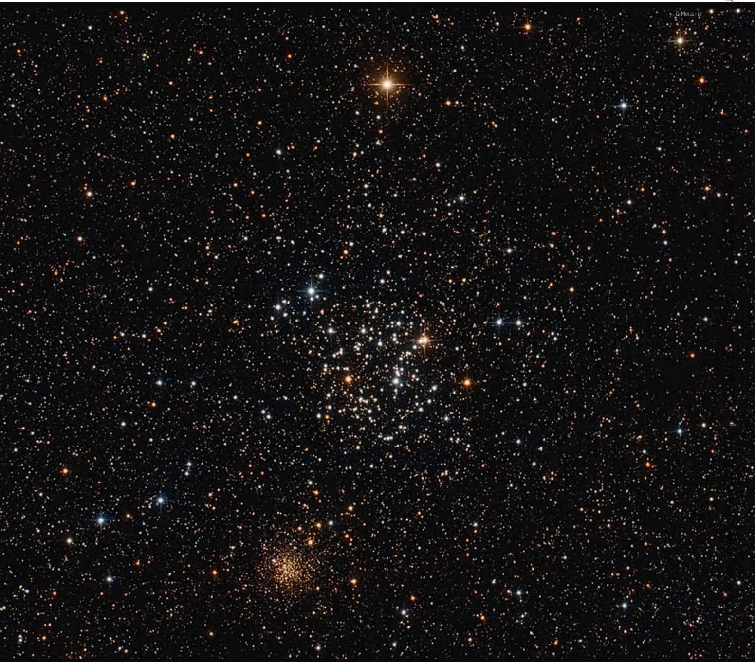
▲ Abb. 10: Aufnahme von M 35 mit einem 5"-f/5Newton mit Komakorrektor, der mit dieser Methode justiert wurde. Auch in den Ecken des APSC-Formats sind die Sterne gleichermaßen kleine Punkte. Also liegt keine Verkipfung des Bildfeldes zur optischen Achse vor.
