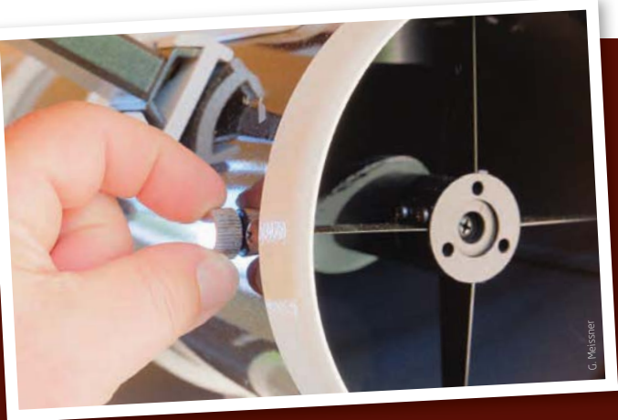
◀ Abb. 2: Der erste Schritt: Die Fangspiegelspinne wird eingestellt. Dabei werden die Justierschrauben am Tubusrand gelockert.
