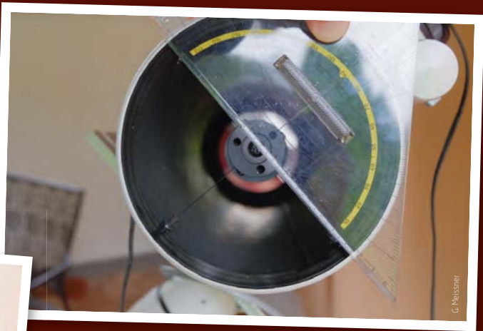
▲ Abb. 3: Die Fangspiegelhalterung ist jetzt in der Mitte des Tubus, die Spinnenblätter sitzen gerade und rechtwinklig zueinander. Der Fangspiegel-Offset wurde beim Aufkleben des Fangspiegels berücksichtigt.
