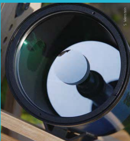
▲ Abb. 1: Unerwünschtes Licht im Tubus: Wo eine Taukappe fehlt, wie bei diesem Schmidt-Cassegrain, macht nicht nur Tau Probleme.
